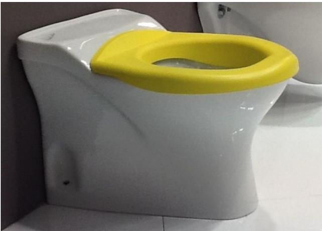
Baby- Boden WC aus Sanitärporzellan weiß. Tiefspül 6 Liter, DIN EN 997: 2012 und EN 33. Geeignet für Babys bis zu 3 Jahren. Höhe 25 cm. Wasserabfluss Ø 100 mm, Wasserzufluss Ø 55 mm. Ausladung 39 cm.
