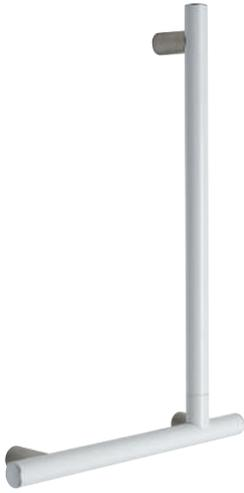
Winkelgriff 400 x 600 mm aus Edelstahl rostfrei Durchmesser 32 mm mit Wandhalterung Durchmesser 31 mm. Tief 82 mm. Wandbefestigung durch Verankerung. Unsichtbare Befestigung. Rechts und links erhältlich.
