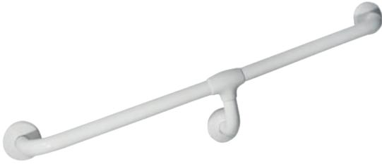
Serie Maxima, Wandhalterung in 90° Winkel verbunden, aus Ø 33 mm Kunststoff, antibakteriell wirksam durch Silberionen Technologie, nahtlos und fugenlos, rutschfest, mit rostfreiem Stahlkern. Verdeckte Befestigung durch Wandrosetten Ø 80 mm aus Edelstahl mit Abdeckkappen. Handlauf wird nach Maß und Angabe gefertigt. Farbe nach Wahl aus der aktuellen Farbpalette.
