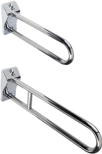
Stützklappgriff Serie Prestigio Plus aus Edelstahl rostfrei. Von der waagerechten Position nach oben klappbar. Von der senkrechten Position nach unten klappbar. Arm Ø 33 mm aus Edelstahl rostfrei Hochglanz poliert, Wandplatte aus Edelstahl mit Abdeckplatte aus Polyamid verchromt.
