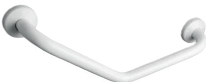
Winkelgriff 135° Serie Maxima, Achsmaß 215 x 470 mm, Schenkellänge waagrecht 275 mm Ø 33 mm aus Kunststoff, nahtlos und fugenlos, rutschfest, mit Stahlkern rostfrei, Wandrosetten Ø 80 mm aus Edelstahl mit Abdeckkappe. Verdeckte Befestigung. Dauerhafte antibakterielle Wirksamkeit durch integrierte Silberionen. Inkl. Edelstahlschrauben und Dübel. Rechts/links einsetzbar. Belastbar nach DIN 18040-1/2. Farbe nach Wahl aus der aktuellen Farbpalette.
