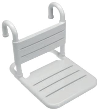
Duscheinhängesitz mit breiten Leisten zum einhängen in Duschhandläufe der Serie MAXIMA und Deu-Waves. Sitzfläche 388 mm x 329 mm. Mit Rückenlehne. Gestell Ø 33 mm aus Kunststoffummantelung. Sitzleisten aus Polyamid. Dauerhafte antibakterielle Wirksamkeit durch integrierte Silberionen. Belastbar nach DIN 18040-1/2. Erhältlich in Standardfarben: Weiß, Lichtgrau, Anthrazitgrau, Limoncello, Vanille, Aubergine, Ruby Red, Blau. Andere Farben auf Anfrage mit Aufpreis.
