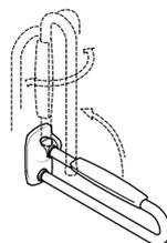
Stützklappgriffe seitlich drehbar mit Armpolster
