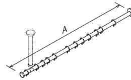
Die Deckenabhängung wird Standard bei 100 mm angebracht. Andere Abstände und Maße auf Anfrage möglich.
