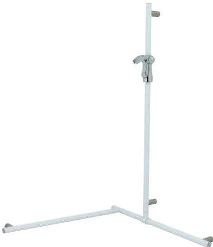
Duschhandlauf mit beweglicher Brausestange und Brausehalter aus Edelstahl. Rostfrei Durchmesser 32 mm mit Wandhalterung Durchmesser 31 mm. Tief 82 mm. Wandbefestigung durch Verankerung. Unsichtbare Befestigung.
