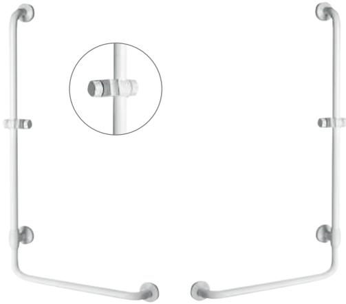
Winkelgriff L-Form Serie Maxima, Mit Brausehalter, Achsmaß 580 x 1120 mm, aus Ø 33 mm Kunststoff, antibakteriell wirksam durch Silberionen Technologie, nahtlos und fugenlos, rutschfest, mit rostfreiem Stahlkern. Verdeckte Befestigung durch Wandrosetten Ø 80 mm aus Edelstahl mit Abdeckkappen. Geeignet für Duscheinhängesitze. Neigung und Höhe des Brausehalters verstellbar. Inkl. Edelstahlschrauben und Dübel. Belastbar nach DIN 18040-1/2. Farbe nach Wahl aus der aktuellen Farbpalette.
