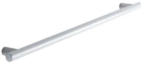
Haltegriff aus Edelstahl rostfrei Durchmesser 32 mm mit Wandhalterung Durchmesser 31 mm. Tief 82 mm. Wandbefestigung durch Verankerung. Unsichtbare Befestigung. Wandstütze und Endkappe verchromt.
