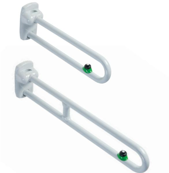
Deu-Waves Stützklappgriff mit elektrischem Impuls. Unsichtbare Verkabelung. Elektrischer Knopf, Schutzart IP67, Kabel für Steuerspannung bis 50 V. = SELV, PELV.
