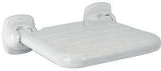
Duschsitz klappbar für Wandmontage. Mit breiten Leisten. Sitzfläche 334 mm x 309 mm aus Polyamid. Gestell aus Kunststoff mit Stahlkern rostfrei. Mit zwei Wandplatten aus Edelstahl mit Abdeckhauben aus Kunststoff. Platzsparend wenn zurückgeklappt. Einfache Montage. Dauerhafte antibakterielle Wirksamkeit durch integrierte Silberionen. Ohne Befestigungsmaterial. Belastbar nach DIN 18040-1/2.
