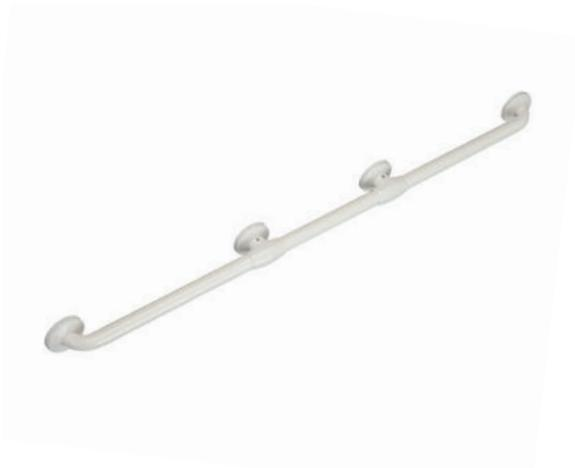
Haltegriff gerade für Bariatrie, Aus  $\varnothing$  33 mm Kunststoff nahtlos, fugenlos und rutschfest mit rostfreiem Stahlkern. Wandrossetten  $\varnothing$  80 mm aus Edelstahl mit Abdeckkappe aus Nylon. Abstand zur Wand von der Innenseite des Griffes 38 mm. Mit zwei zusätzlichen Wandstützen bei jedem Abstand von 50 cm eingebracht. Achsmaß: 917mm. Verdeckte Befestigung. Befestigungsmaterial im Lieferumfang enthalten. Dauerhafte antibakterielle Wirksamkeit durch integrierte Silberionen
