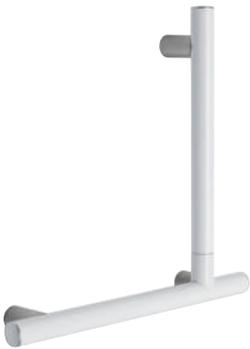
Winkelgriff 400 x 400 mm aus Edelstahl rostfrei Durchmesser 32 mm mit Wandhalterung Durchmesser 31 mm. Tief 82 mm. Wandbefestigung durch Verankerung. Unsichtbare Befestigung. Rechts und links erhältlich.
