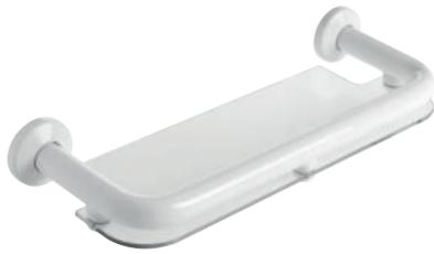
Ablage für durchgehenden Spiegel mit Griff aus Stangensystem, Tiefe 165 mm, Abstand zur Wand 20 mm. Griff Ø 33 mm antibakteriell durch Silberionen Technologie. Ablage aus Sicherheitsglas 6 mm, verdeckte Befestigung durch Wandrosetten aus Edelstahl Ø 72 mm. Inkl. Edelstahlschrauben und Dübel. Farbe nach Wahl aus der aktuellen Farbpalette.
