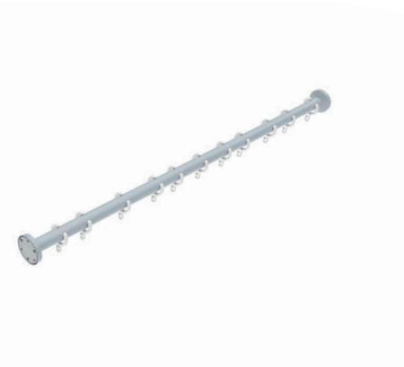
Deu-Waves Duschvorhangstange aus Ø 33 mm Polyamid mit Aluminiumkern. Verdeckte Befestigung durch Wandrosetten Ø 72 mm aus Edelstahl mit Abdeckkappen. Stange bauseits beliebig kürzbar. Mit Vorhangringen aus POM. Inkl. Edelstahlschrauben und Dübel. Farbe nach Wahl aus der aktuellen Farbpalette. Passende Duschvorhänge sind aus der Serie Eifa zu wählen. Ab 180 cm gibt es ein Verbindungsstück für die Aufnahme einer Deckenabhangung. Andere Maße auf Anfrage
