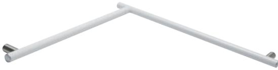
Duschhandlauf aus Edelstahl rostfrei Durchmesser 32 mm mit Wandhalterung Durchmesser 31 mm. Tief 82 mm. Wandbefestigung durch Verankerung. Unsichtbare Befestigung. Wandstütze und Endkappe verchromt.
