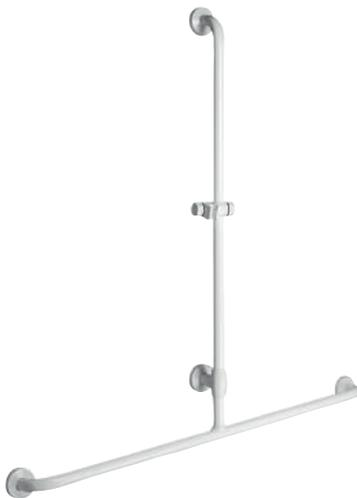
Duschhandlauf Serie Maxima, mit Brausestange und Brausehalter, T-Form, Achsmaß 1160 mm x 1120 mm hoch, aus Ø 33 mm Kunststoff, antibakteriell wirksam durch Silberionen Technologie, nahtlos und fugenlos, rutschfest, mit rostfreiem Stahlkern. Verdeckte Befestigung durch Wandrosetten Ø 80 mm aus Edelstahl mit Abdeckkappen. Neigung und Höhe des Brausehalters verstellbar. Inkl. Edelstahlschrauben und Dübel. Für Duscheinhängesitze geeignet. Farbe nach Wahl aus der aktuellen Farbpalette.
