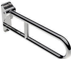
Stützklappgriff Serie Prestigio Plus aus Edelstahl rostfrei. Von der waagerechten Position nach oben klappbar. Von der senkrechten Position nach unten klappbar. Arm Ø 33 mm aus Edelstahl rostfrei Hochglanz poliert, Wandplatte aus Edelstahl mit Abdeckplatte aus Polyamid verchromt.
