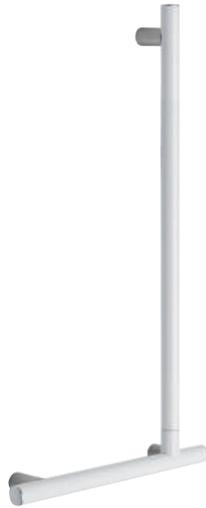
Winkelgriff 500 x 700 mm aus Edelstahl rostfrei Durchmesser 32 mm mit Wandhalterung Durchmesser 31 mm. Tief 82 mm. Wandbefestigung durch Verankerung. Unsichtbare Befestigung. Rechts und links erhältlich.
