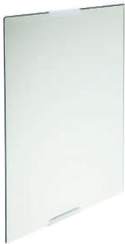
Badzimmerspiegel kippbar, Sicherheitsglas. Unterstützt mit einer Stahlplatte. Wandverankerung mittels Stahlbügel mit kontrolliertem Widerstandsreibungssystem zum Kippen. • Sicherheitsglas, 5 mm dick • Außenkante mit rundem poliertem Draht behandelt • Wandmontage mittels Stahlbügel • Spiegelneigung bis 11 Grad • Neigungswiderstand durch Reibung steuerbar • Halterung mit verzinkter Stahlplatte.
