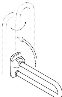
Stützklappgriffe seitlich drehbar
