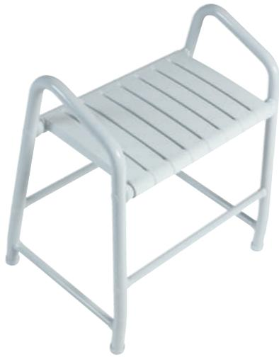
Duschhocker mit Sitzfläche 496 x 334 mm, Höhe 465 mm aus Nylon mit integrierten Silberionen. Gestell aus Ø 33 mm Stangensystem - Stahlrohr rostfrei mit Ummantelung aus Kunststoff mit Silberionen. Dauerhafte antibakterielle Wirksamkeit durch Silberionen Technologie. Mit seitlichen Griffen für noch mehr Sicherheit. Last: bis zu 225 KG. Erhältlich in D2 Lichtgrau, D4 Anthrazit, Y3 Limoncello, I2 Vanille, W1 Weiß
