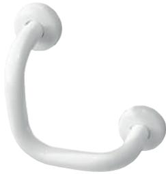
Winkelgriff 90° Serie Maxima, Achsmaß 200 mm x 200 mm, Ø 33 mm aus Kunststoff, nahtlos und fugenlos, rutschfest, mit Stahlkern rostfrei. Wandrosetten Ø 80 mm aus Edelstahl mit Abdeckkappe. Verdeckte Befestigung. Dauerhafte antibakterielle Wirksamkeit durch integrierte Silberionen. Rechts und Links einsetzbar. Dient zum Halten und Hochziehen mit der Hand oder mit dem Ellbogen. Inkl. Edelstahlschrauben und Dübel. Belastbar nach DIN 18040-1/2. Farbe nach Wahl aus der aktuellen Farbpalette.
